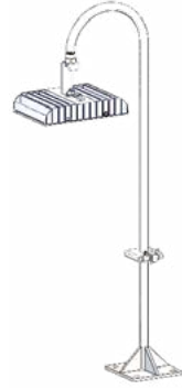
instalação luminária pendente em “pescoço de ganso” - CALM
