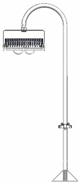
Instalação em poste pescoço de gancho*
