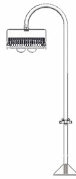
instalação luminária pendente em “pescoço de ganso” - CELE
